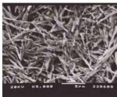
Legenda: obtido via síntese solvotérmica em meio acético (180°C/24h); @ 5.000x, escala de 5  $\mu\text{m}$ .
