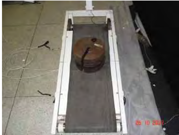
Figura 3.15 – Calibração vertical dos canais pares da plataforma
