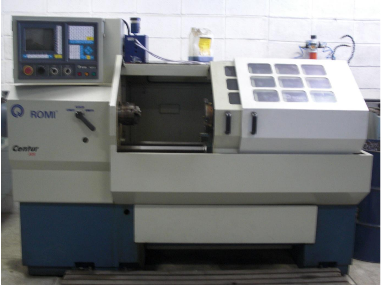
Figura 6 – Torno CNC Romi CENTUR 30S utilizado para a realização dos ensaios.
