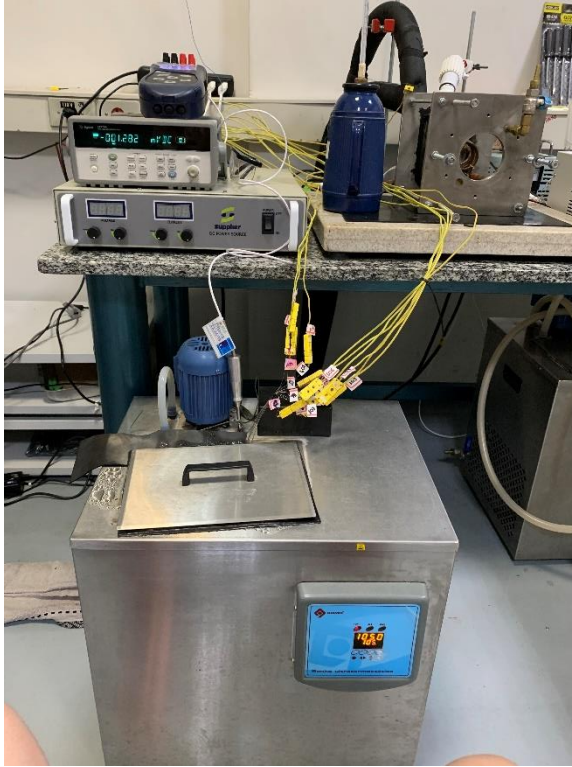
Figura A1 - Aparato experimental utilizado para calibração de termopares.
