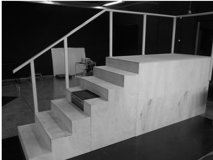
Figura 3.1 Escada sem o tapete emborrachado e com a plataforma de força acoplada ao quarto degrau.
