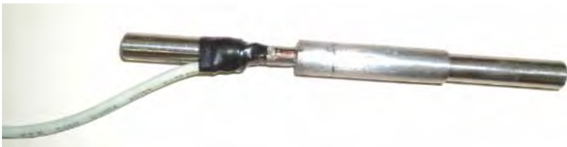
Figura 29 - Corpo de prova para o ensaio de flexão.
