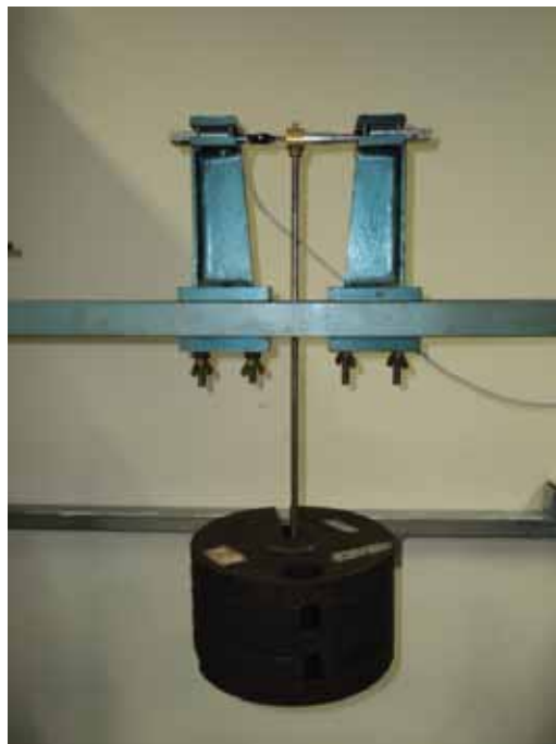
Figura 33 - Aplicação de carregamento para ensaio de flexão
