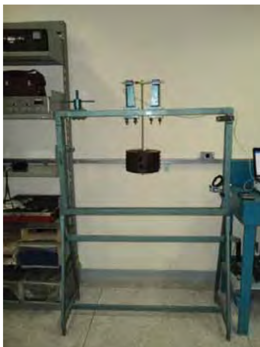
Figura 30 - Configuração para o ensaio de flexão.
