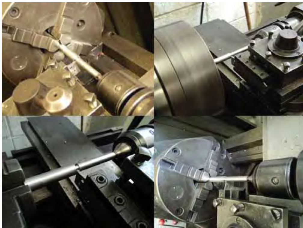
Figura 23 - Processo de usinagem dos eixos de transmissão.
