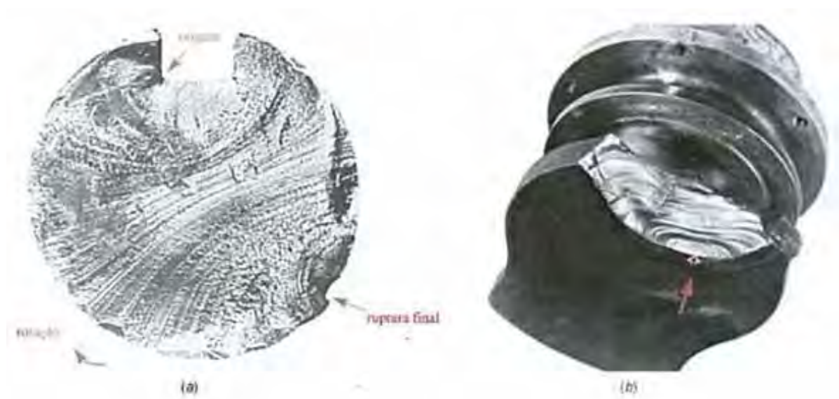
Figura 2 - Características de falhas por fadiga – (Fonte: Norton, 2006, p. 305).
