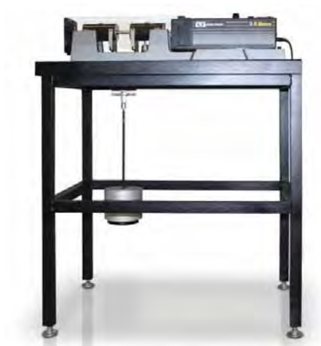
Figura 36 - Instron R. R. Moore para ensaio de fadiga por flexão rotativa – (Fonte: Instron ).
