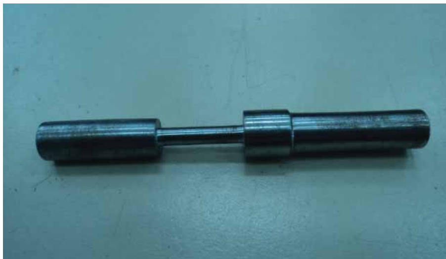
Figura 35 - Corpo de prova para ensaio de fadiga.
