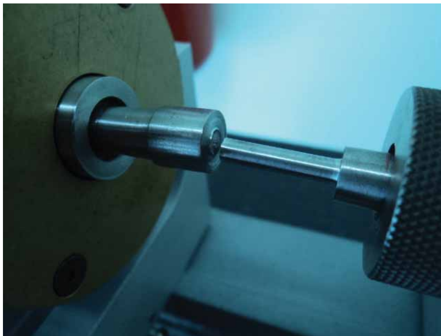
Figura 47 - Corpo de prova fraturado.
