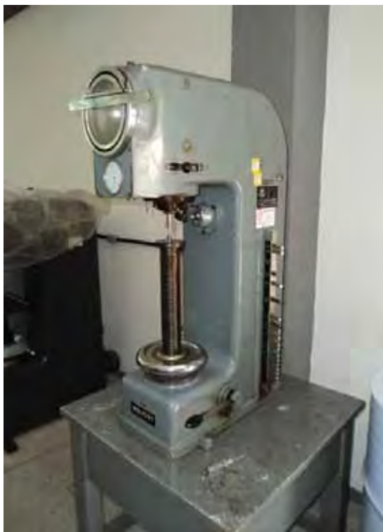
Figura 28 - Máquina de ensaio de dureza Rockwell .
