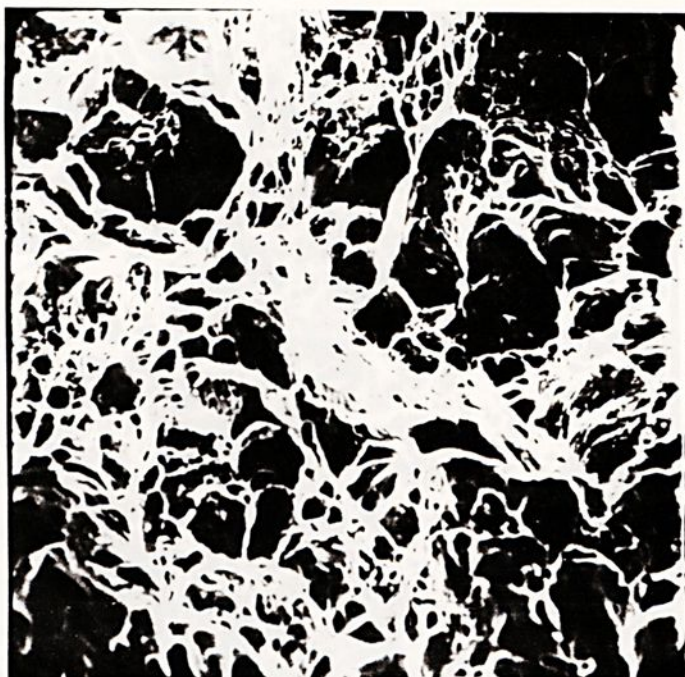
FIGURA 4.42 - Superfície de fratura do aço bifásico ao carbono, envelhecido à temperatura de 150^{\circ}\text{C} por 3 \times 10^2 segundos. Micromecanismo de fratura dútil - predominância de dimples. Existência de pequenas inclusões. MEV - 1400 x.
