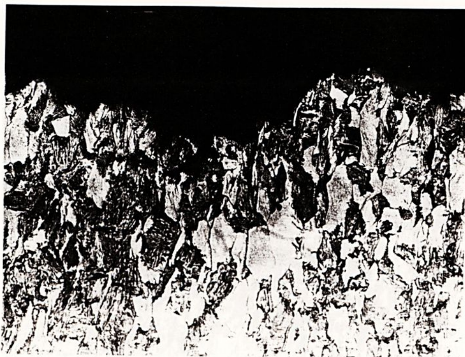
FIGURA 4.16 - Microestrutura bifásica do aço ao carbono, obtida por têmpera intercrítica de descida a partir de 760°C, atacada com nital 2%. Vista lateral da região de fratura. Os grãos se encontram alongados. Microscópio ótico. 670 x.
