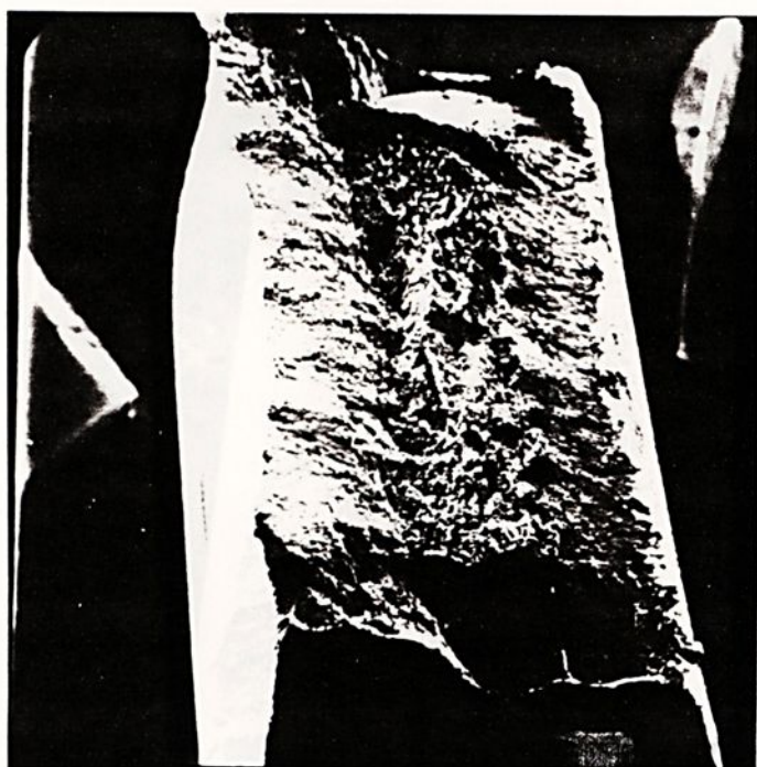
FIGURA 4.35 - Superfície de fratura do aço bifásico microligado, envelhecido à 80°C por 3 \times 10^2 segundos. Aspecto macroscópico de fratura dúctil - superfície irregular. MEV - 29 x.
