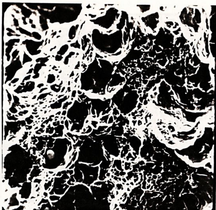
FIGURA 4.52 - Superfície de fratura do aço microligado envelhecido à 150°C por 864 \times 10^2 segundos. Micromecanismo de fratura dúctil - superfície repleta de dimples. Presença de precipitados. MEV - 1450 x.
