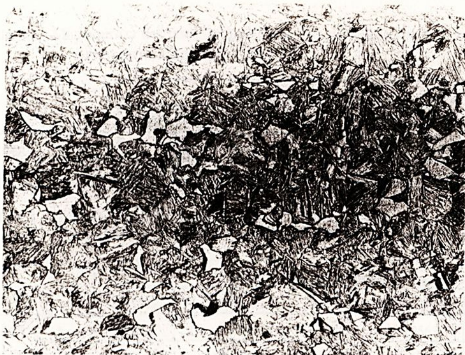
FIGURA 4.2 - Microestrutura do aço bifásico microligado, submetido à têmpera intercrítica de descida a partir de 760°C, atacada com nital a 2%. Microscópio ótico. 670 x.
