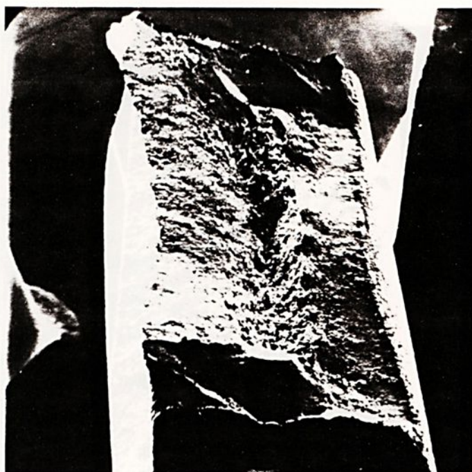
FIGURA 4.31 - Superfície de fratura do aço bifásico ao carbono, envelhecido à 80°C por 9 \times 10^2 segundos. Aspecto macroscópico de fratura dúctil - deformações e superfície irregular. MEV - 29 x.
