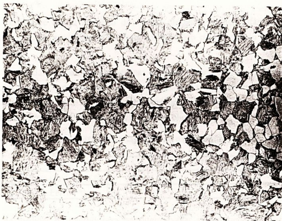
FIGURA 4.1 - Microestrutura do aço bifásico ao carbono, obtida por têmpera intercrítica de descida a partir de 760^{\circ}\text{C} , atacada com nital a 2%. Microscópio ótico. 670 x.
