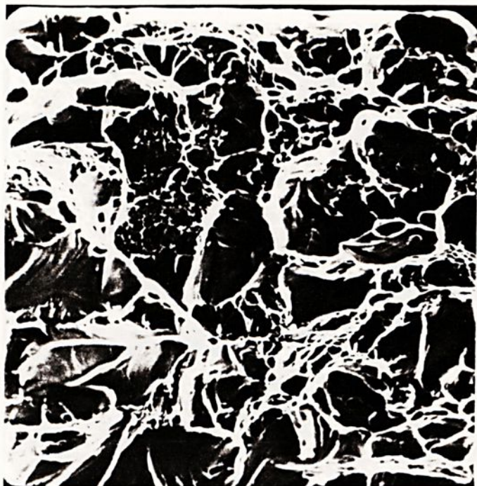
FIGURA 4.30 - Superfície de fratura do aço bifásico ao carbono, envelhecido à 80°C por 3 \times 10^2 segundos. Micromecanismo de fratura mista - presença de dimples e facetas de clivagem. MEV - 1500 x.
