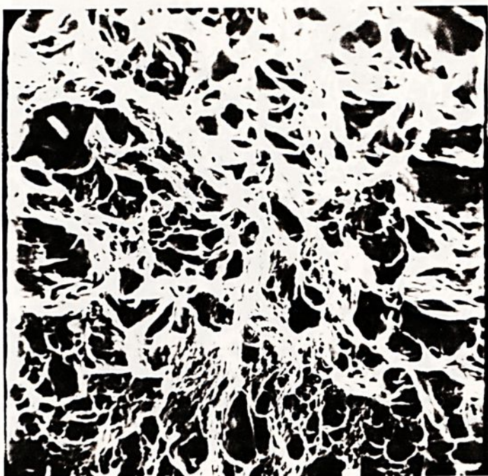
FIGURA 4.48 - Superfície de fratura do aço bifásico microligado, envelhecido à temperatura de 150^{\circ}\text{C} por 3 \times 10^2 segundos. Micromecanismo de fratura dúctil - superfície repleta de dimples. Presença de inclusões. MEV - 1470 x.
