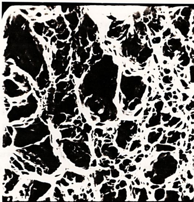
FIGURA 4.56 - Superfície de fratura do aço bifásico microligado envelhecido à temperatura ambiente por 2.160 \times 10^2 segundos. Detalhe de inclusões. MEV - 3000 x.
