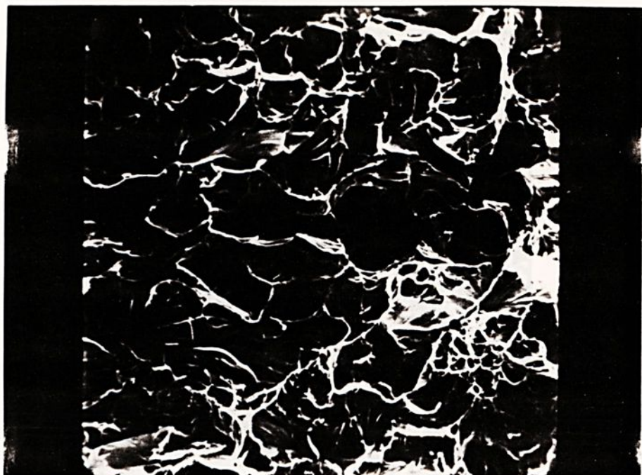
FIGURA 4.24 - Superfície de fratura do aço bifásico ao carbono, obtida por têmpera intercrítica de descida a partir de 760^{\circ}\text{C} . Presença de dimples e facetas de clivagem. Região-média. MEV - 1130 X.
