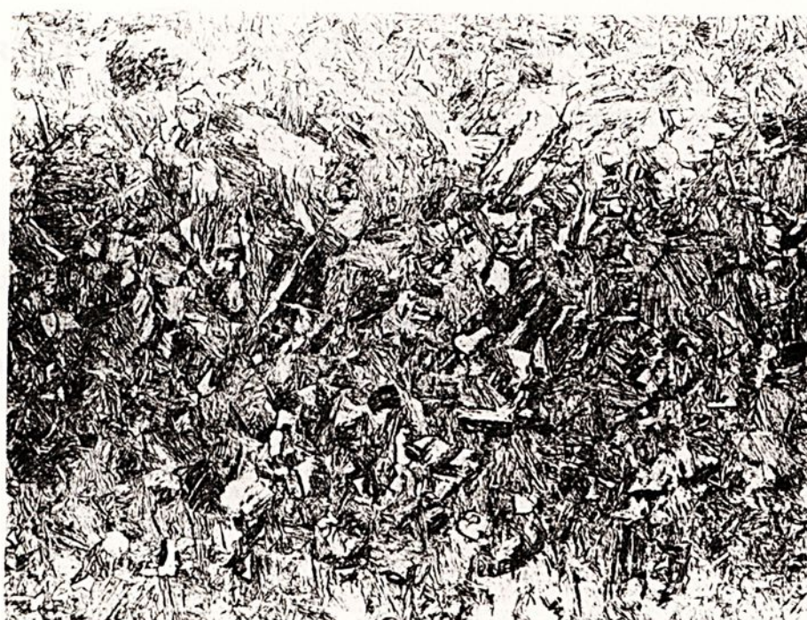
FIGURA 4.17 - Microestrutura bifásica do aço microligado, obtida por têmpera intercrítica de descida a partir de 760°C, atacada com nital 2%. Região próxima a superfície de fratura. Os grãos de ferrita são menores que os da figura 4.4 e a martensita apresenta "ripada". Microscópio ótico. 670 x.
