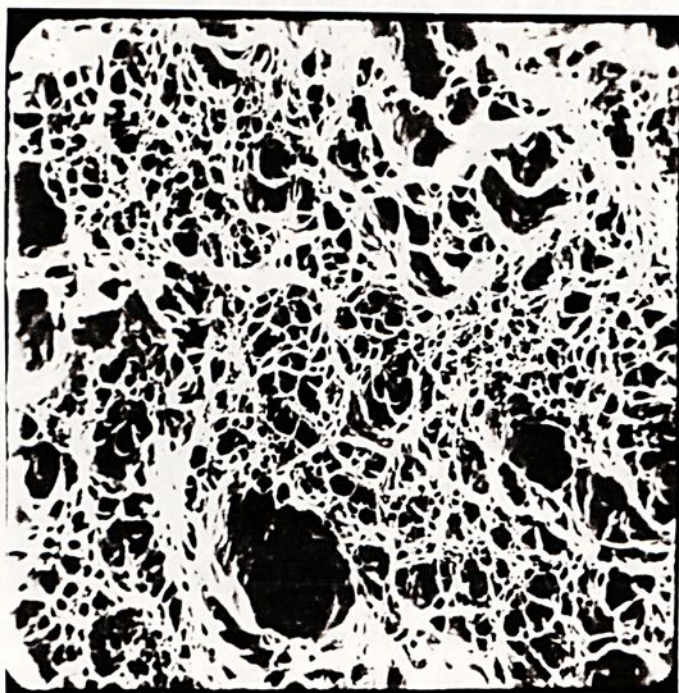
FIGURA 4.26 - Superfície de fratura do aço bifásico microligado, obtido por têmpera intercrítica de descida a partir de 760^{\circ}\text{C} . Superfície repleta de dimples. Região-borda. MEV - 1400 x.
