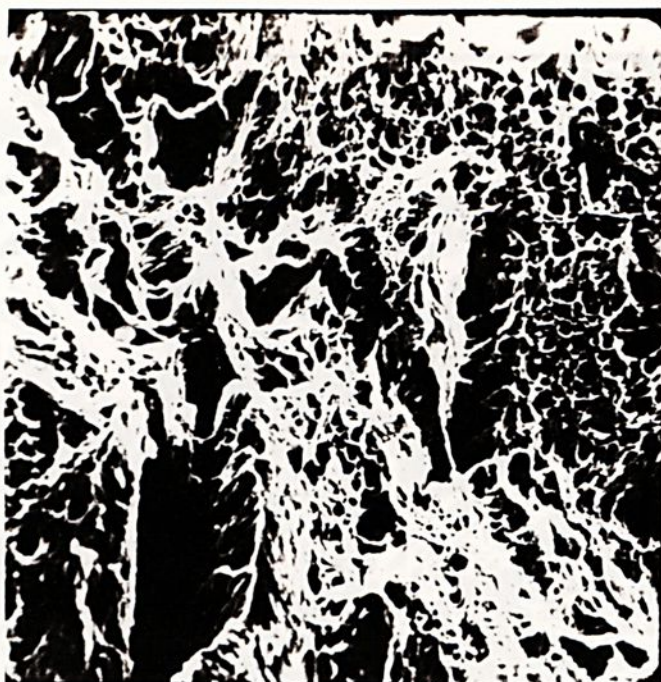
FIGURA 4.28 - Superfície de fratura do aço bifásico microligado, obtido por têmpera intercrítica de descida a partir de 760°C. Superfície repleta de dimples, presença de inclusões e aparecimento de trinca. Região-central. MEV - 1350 X.
