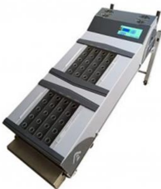
Figura 5: Esteira motorizada para camundongos com 8 baias. Dimensões em mm (A x L x C): 320 x 570 x 1440.
