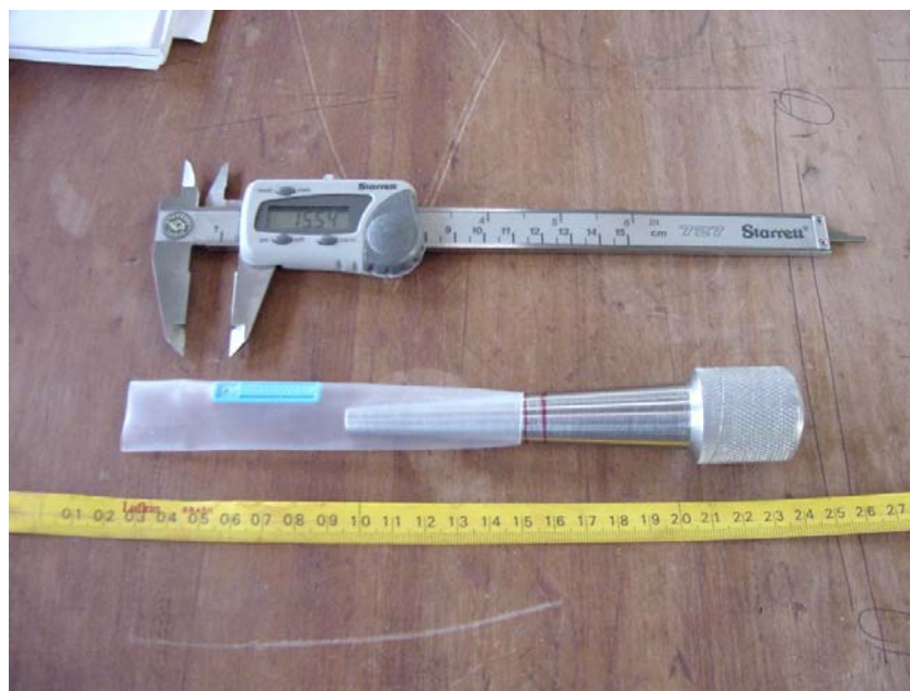
Figura 11. Ferramenta cônica e paquímetro digital para determinar o diâmetro interno do tubo emissor.
