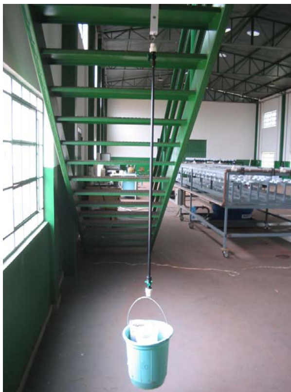
Figura 13. Dispositivo de medida de tração a 180 N.
