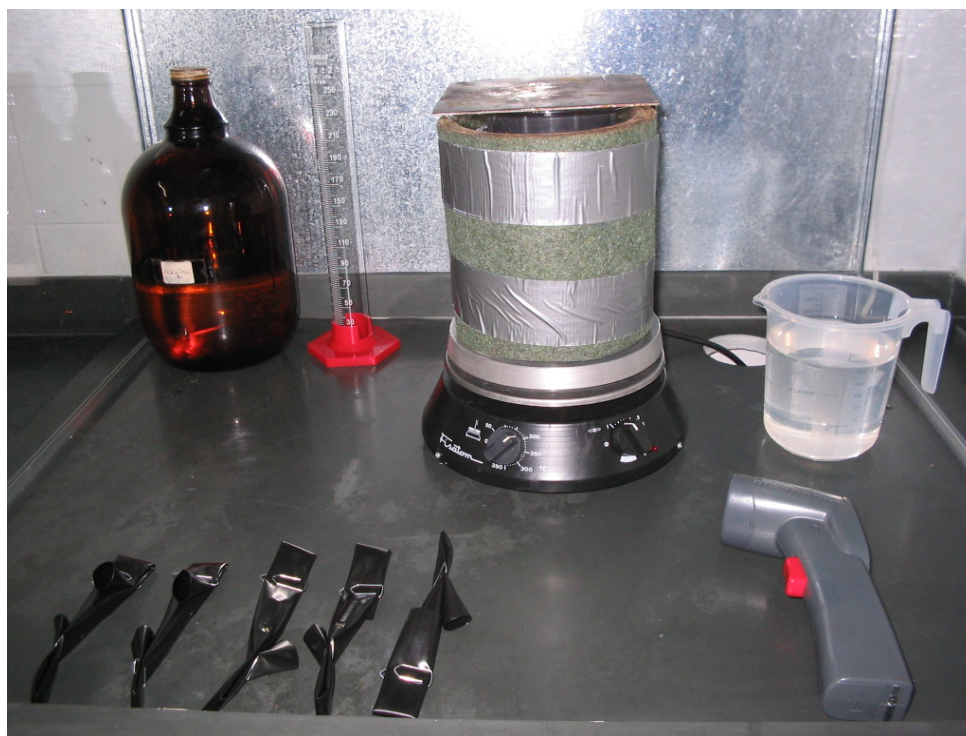
Figura 15. Equipamentos usados para a avaliação da suscetibilidade ao rachamento por estresse ambiental.
