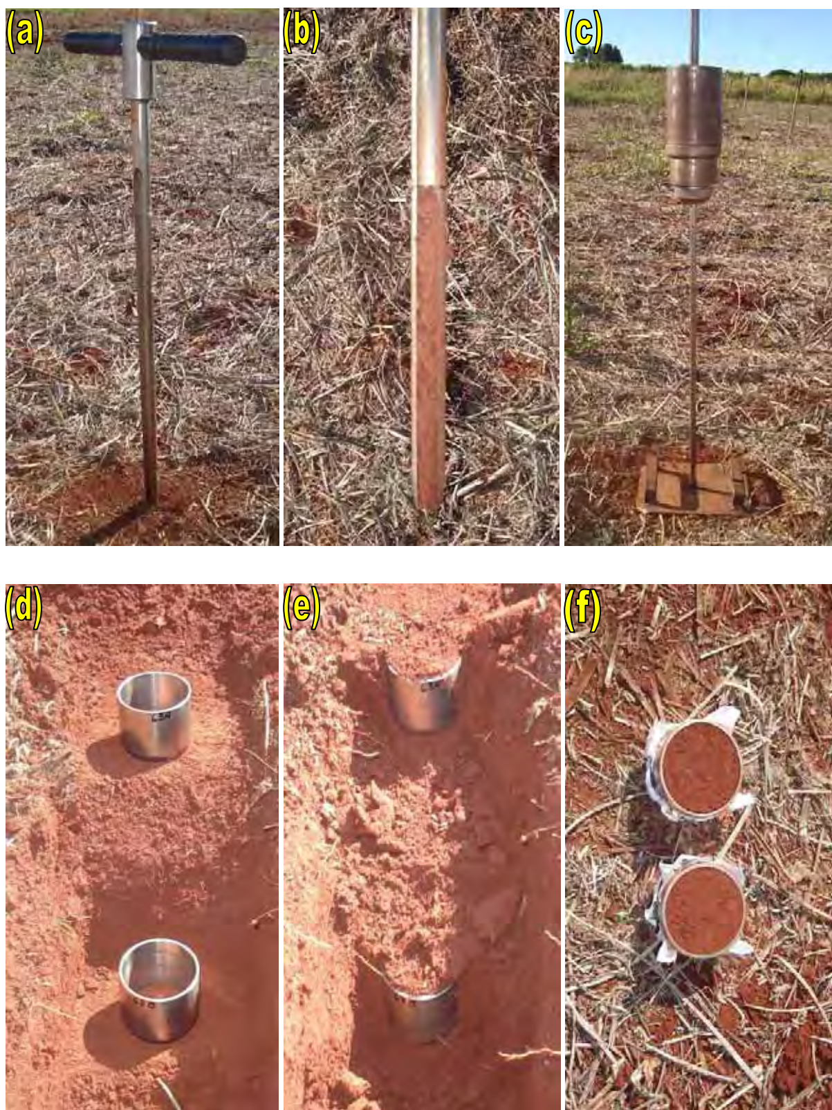
APÊNDICE E. (a) e (b) Detalhe da sonda na coleta da umidade do solo; (c) Detalhe da coleta da resistência mecânica; (d) e (e) Vista da coleta das amostras indeformadas do solo; e (f) Detalhe das amostras indeformadas do solo.
