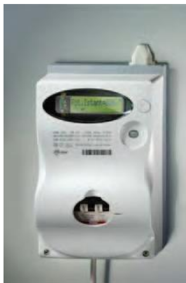
Figura 5 – Smart Meter monofásico do projeto Telegestore
