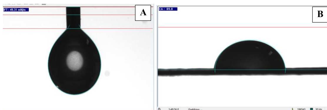
Figura 1: Análise da Tensão Superficial (A). Análise do Ângulo de Contato (B).
