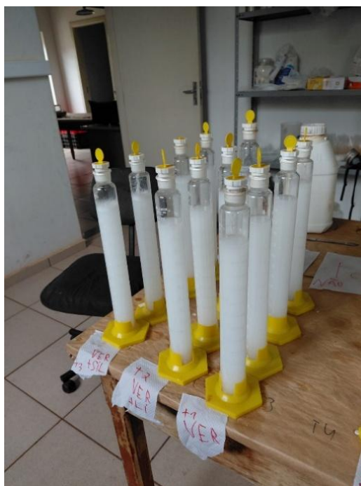
Figura 2: Provetas contendo as caldas fitossanitárias para ser analisado o pH e a condutividade elétrica.
