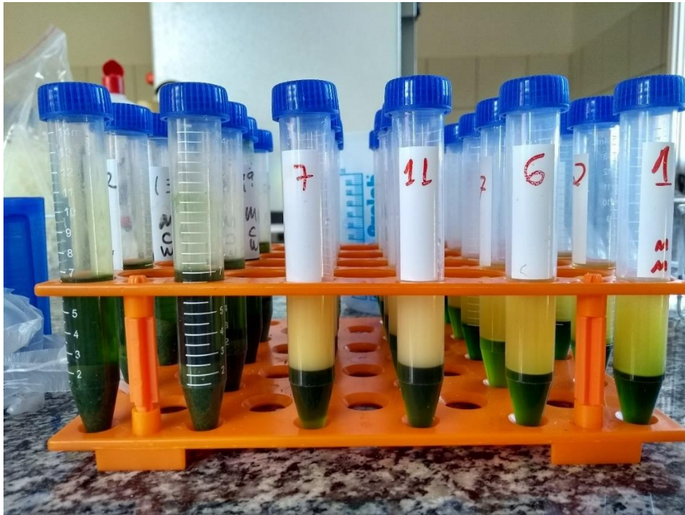
Figura 8 – Extração de compostos em MCW para análise de perfil de metabólitos, com ênfase na etapa de separação de fases lipossolúvel e hidrossolúvel.
