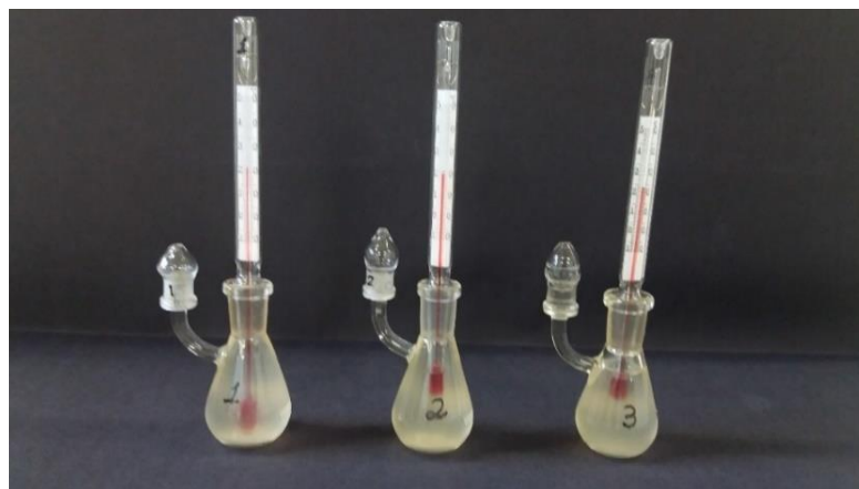
Figura 7 – Picnômetro utilizado para determinação de densidade
