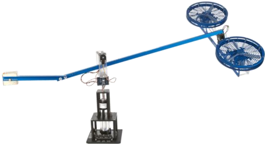
Figura 3 – Helicóptero de bancada, 3-DOF helicopter.
