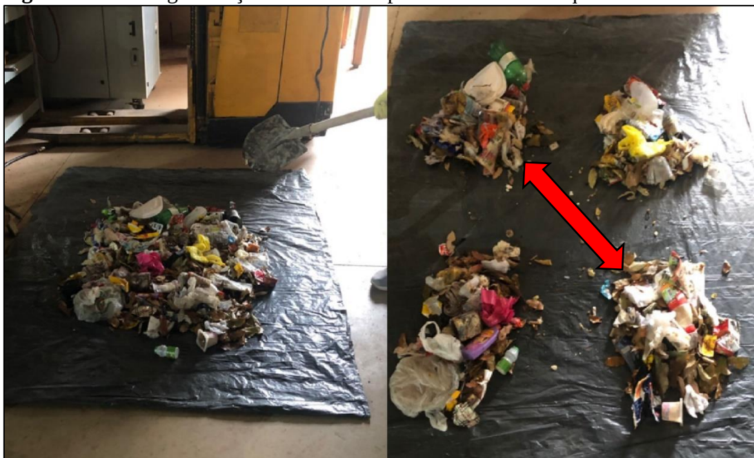
Figura 32 - Homogeneização da amostra a partir do método de quarteamento
