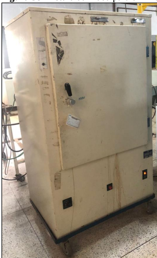
Figura 38 - Estufa utilizada para diminuição da umidade
