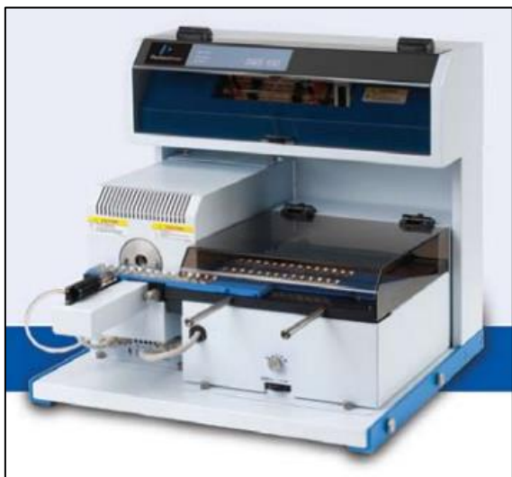
Figura 40 - Espectrômetro de absorção atômica dedicado para quantificação de mercúrio total em amostras sólidas
