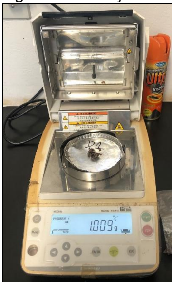
Figura 36 - Balança de umidade à infravermelho para determinação de umidade
