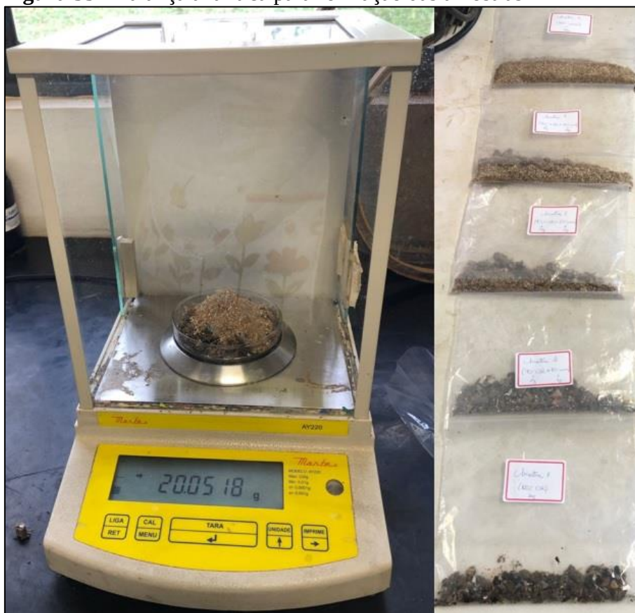
Figura 35 - Balança analítica para formação das amostras
