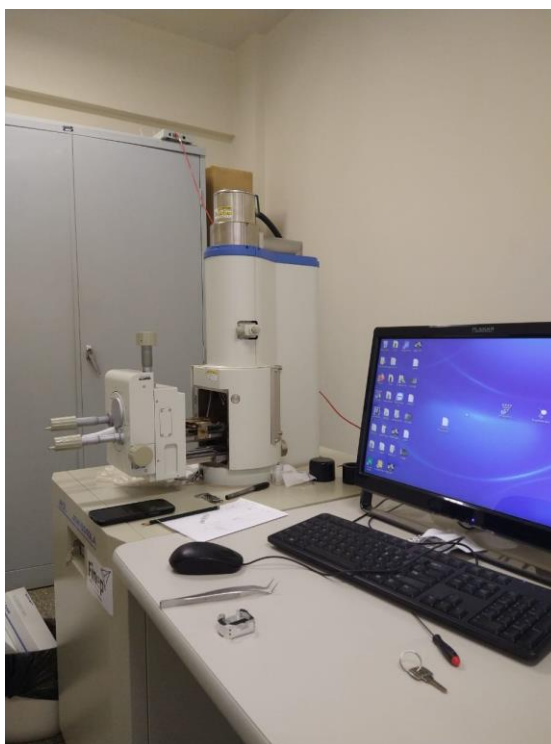
Figura 11 - Microscópio eletrônico de Varredura com EDS acoplado modelo JEOL JSM-6010 LA.
