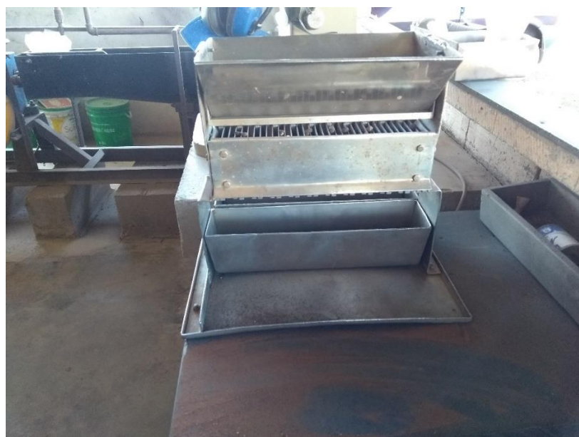
Figura 8 - Quarteador Jones utilizado para a redução de material.
