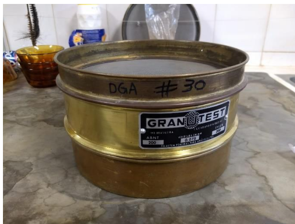
Figura 9 - Jogo de peneiras utilizadas para o corte e separação das frações utilizadas no trabalho.
