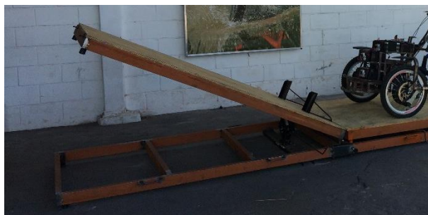
Plataforma de inclinação longitudinal variável
