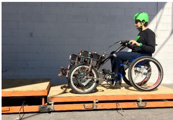
Figura 80 – Ensaio de capacidade para transposição de obstáculo. Fonte: AUTOR, 2017.
