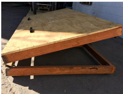
Figura 73 – Plataforma construída para análise de estabilidade lateral. Fonte: AUTOR, 2017.
