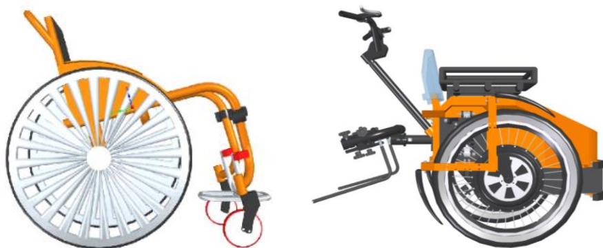
Figura 41 – Parte frontal motorizada do veículo para acoplamento em cadeira de rodas. Fonte: AUTOR, 2017
