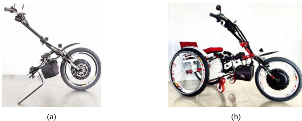
Figura 19 - KIT LIVRE: (a) desacoplado; (b) acoplado na cadeira de rodas. Fonte: KIT LIVRE, 2017.
