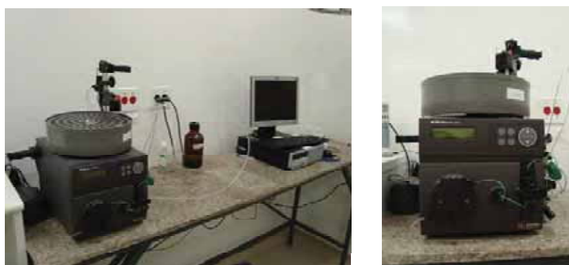
Figura 15. Aparelho ÄKTA prime plus, utilizado para purificação das amostras de líquido ascítico obtidas.
