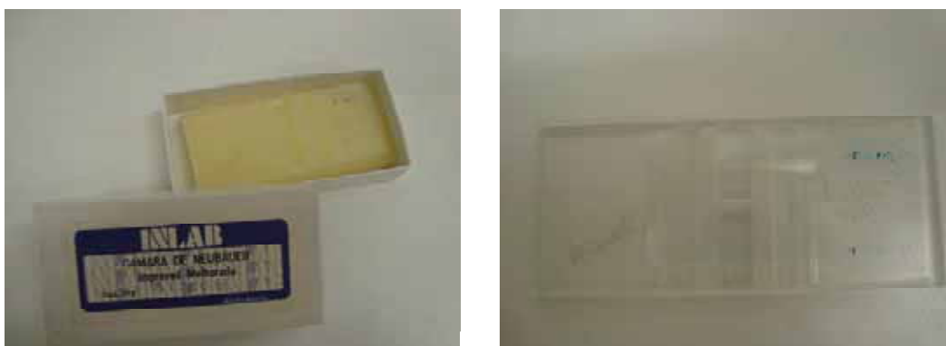
Figura 10. Câmara de Neubauer, utilizada para determinação de viabilidade celular e contagem de células totais.
