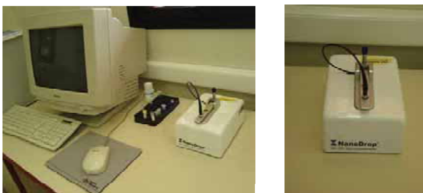
Figura 14. Nanodrop ND1000, aparelho utilizado para determinação de proteínas totais.
