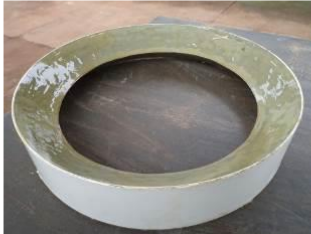
Figura 9 - Fotografia do defletor de gases
