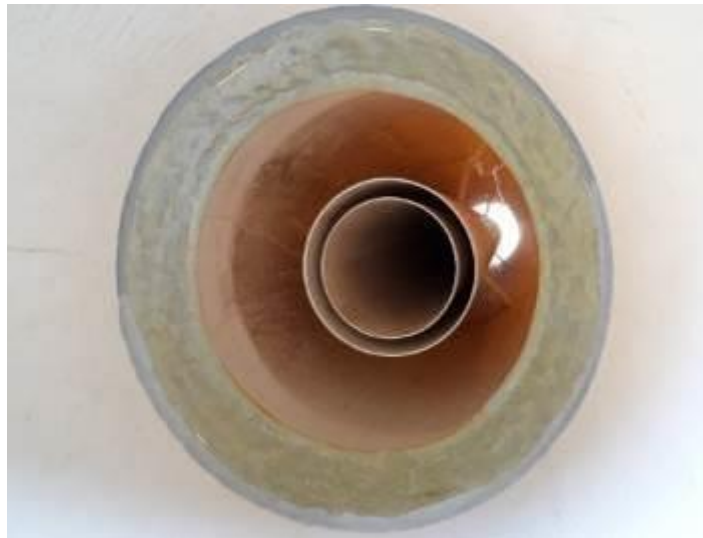
Figura 10 - Fotografia do defletor instalado no RUC
