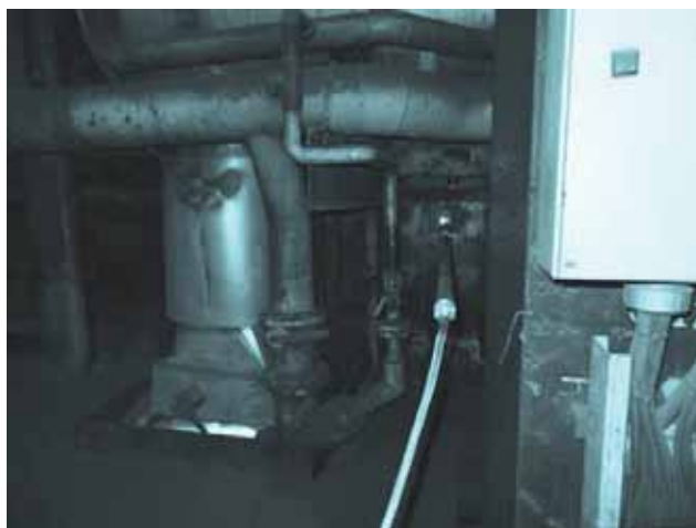
Figura 5.7 – Fotografia da região à direita do queimador, onde uma lança de aço inox foi colocada no forno com o medidor de pressão em sua extremidade.
