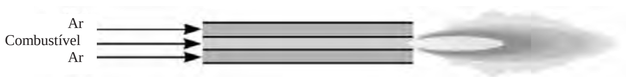
Figura 3.3 - Desenho esquemático de um queimador por difusão. (BAUKAL, 2004).
