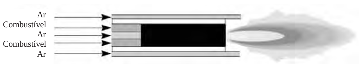
Figura 3.4 - Desenho esquemático de um queimador de pré-mistura parcial. (BAUKAL, 2004).
