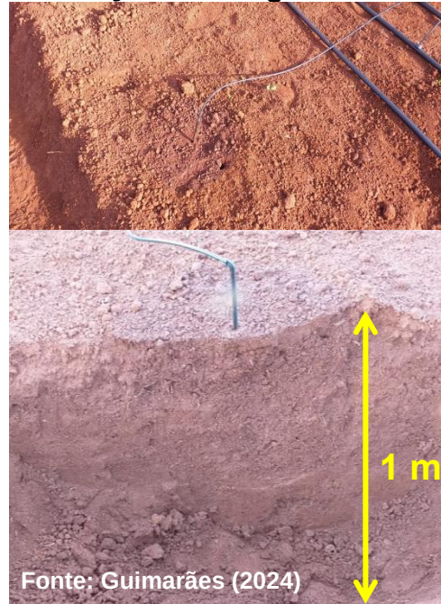
Figura 23 – Abertura da trincheira no centro do bulbo molhado para determinação da sua geometria
