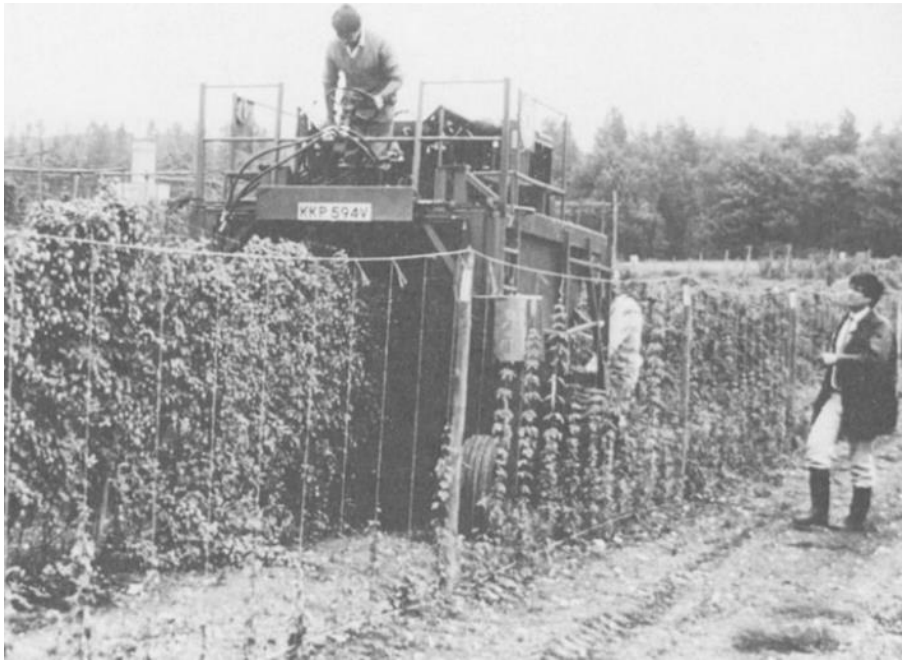
Figura 5 - Sistema fixo do tipo treliça baixa para condução dos ramos com colheita mecanizada dos cones
