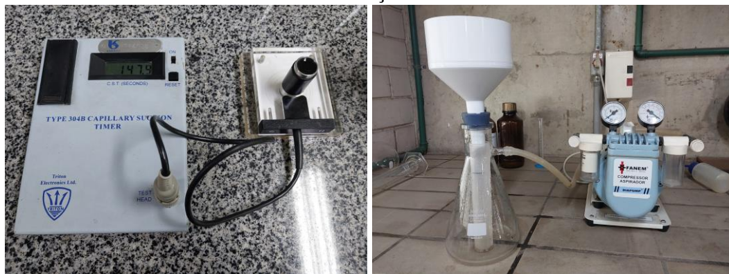
Figura 16 - Registro fotográfico dos recursos instrumentais para ensaio de CST e de tempo de filtração
