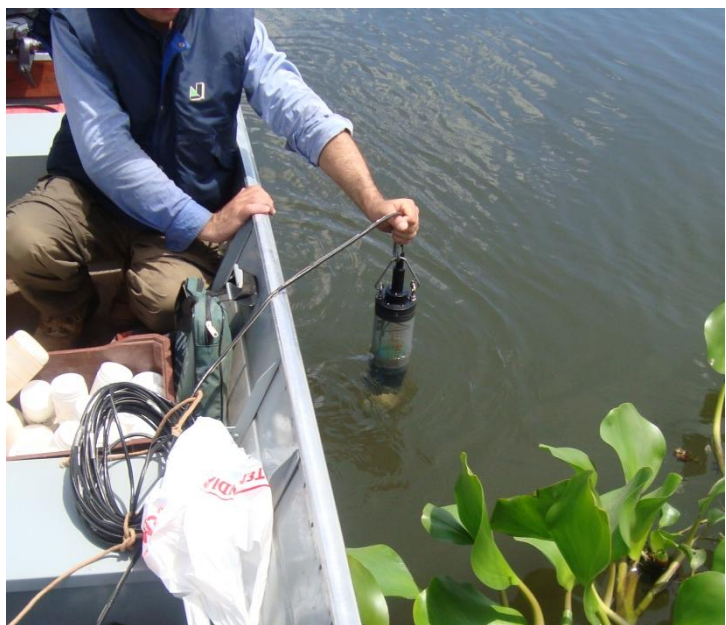
Obtenção de variáveis limnológicas através de Sonda Eureka Manta 2.
