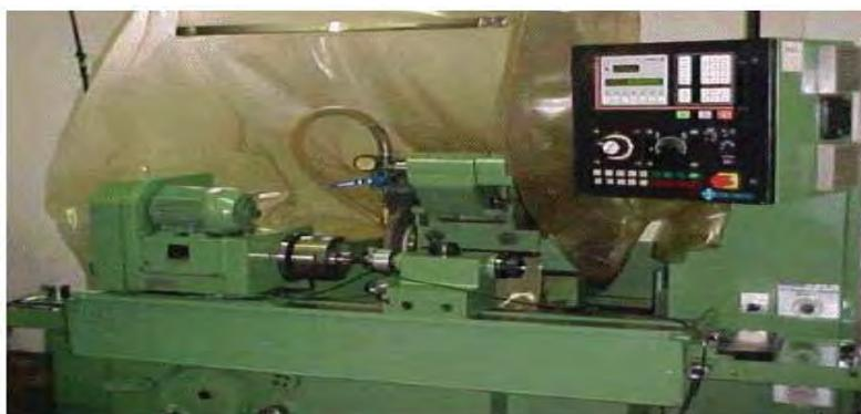
Figura 4.1. Retificadora cilíndrica universal, CNC.
