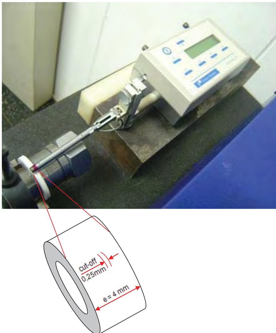
Figura 4.8. Operação de medição de rugosidade.
