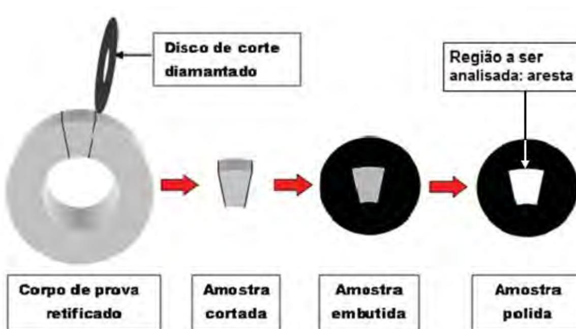
Figura 4.12. Preparação da amostra para microscopia (MEV)
