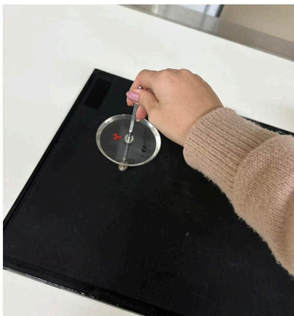
FIGURA 23 - Procedimento experimental de análise da densidade óptica com filme radiológico (cassete CR) para avaliação da distribuição de dose emitida pela fonte de Sr-90.
