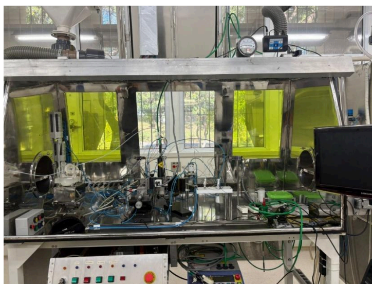
FIGURA 14 - Segunda célula quente "hotcell", onde ocorre o processo de encapsulamento e soldagem.
