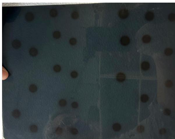
Figura 26 - Filme de controle de qualidade radioterápico (Kodak X-Omat V) após exposição à fonte de Sr-90. As regiões de interesse (ROIs) definidas foram posteriormente avaliadas em densitômetro óptico para extração dos valores médios de D.O.
