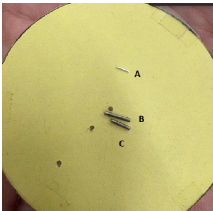
FIGURA 13 - Demonstração do processo de fabricação das sementes de Iodo-125. (A) Núcleo com iodeto de prata na superfície. (B) Cápsula cilíndrica. (C) Semente já finalizada após o processo de solda.
