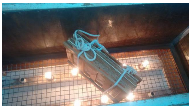
Figura 4. Material prensado sendo seco na estufa de circulação de ar.
