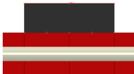
Figura 4 – Interação de corpo rígido entre a placa de carregamento e o RP-1.
