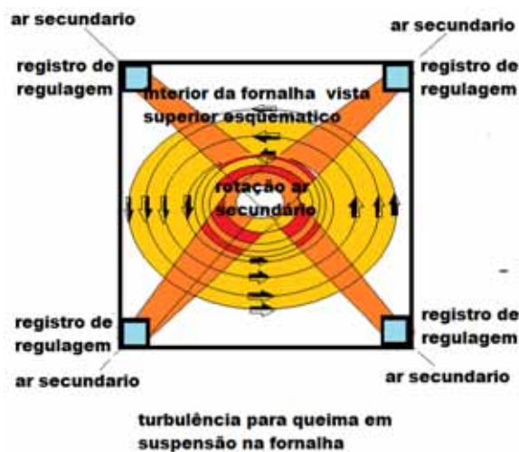
Figura 24: Entrada do ar secundário realizando a turbulência na câmara de combustão.
