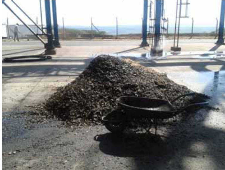
Figura 66: Acúmulo de material não queimado
