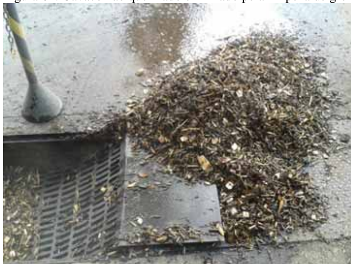
Figura 64: Cavaco não queimado eliminado pela limpeza de grelha
