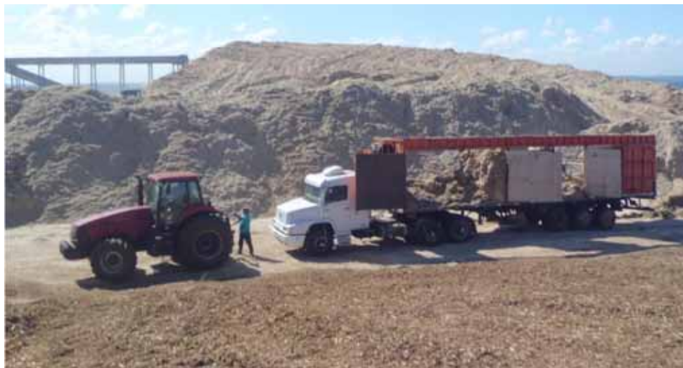
Figura 38: Descarregamento de biomassa no pátio de bagaço
