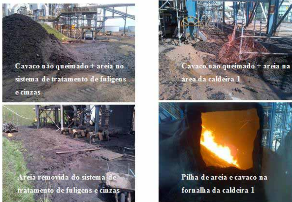
Figura 54: Problemas após o teste de 10 dias da queima com cavaco de madeira.
