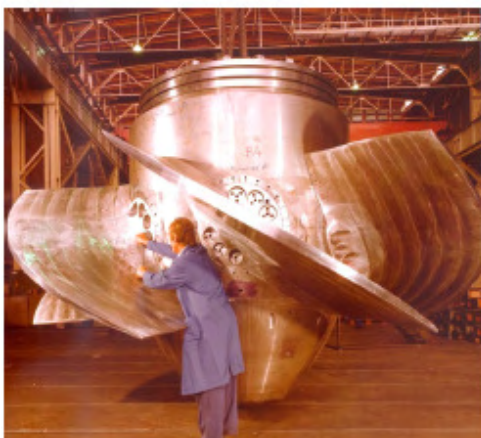
Figura 4.6 – Fotos de turbinas Kaplan – Fonte: (VATECH, 2006)
