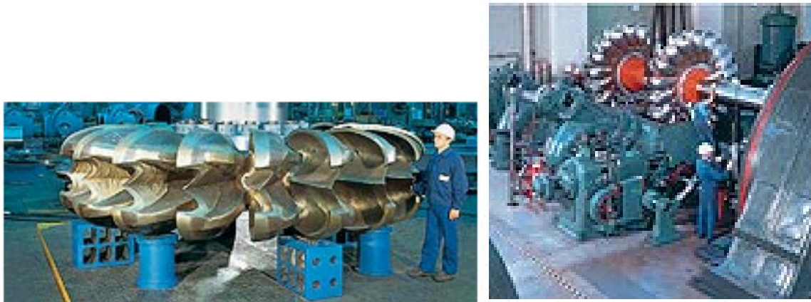
Figura 4.8 – Fotos de turbinas Pelton – Fonte: (VOITH, 2006)
