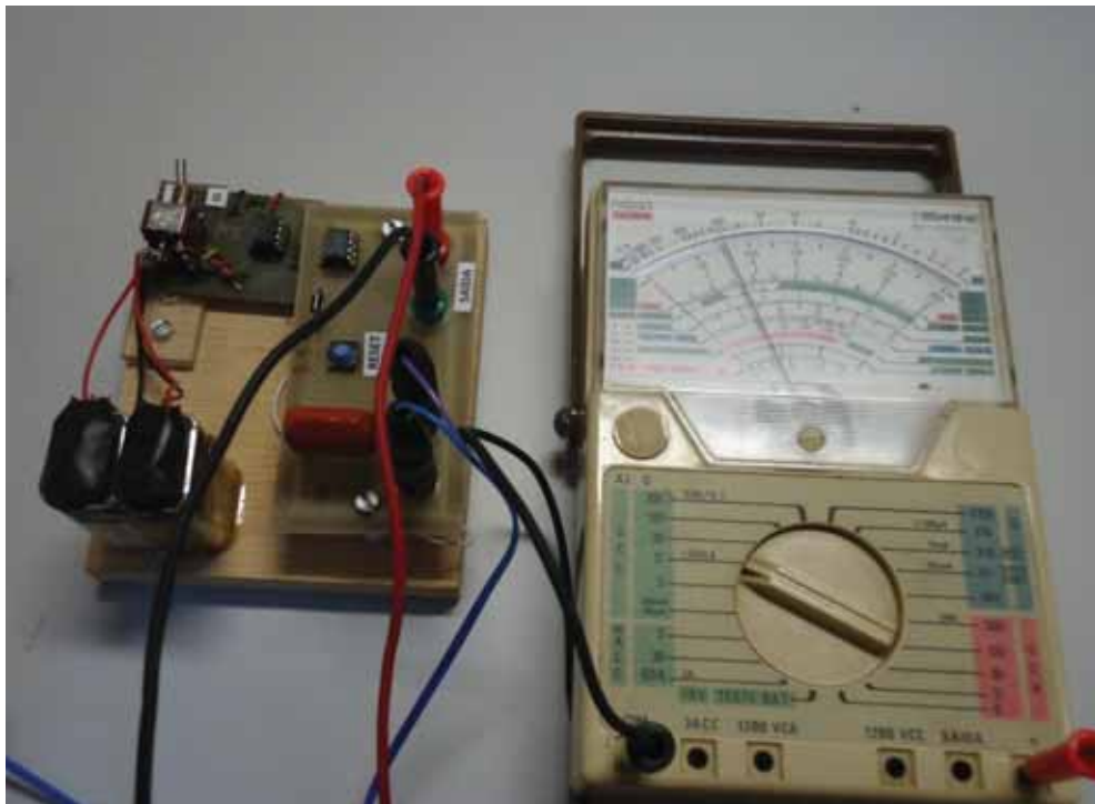
Figura 22 - Circuito externo utilizado para o armazenamento de energia elétrica juntamente com um multímetro.
