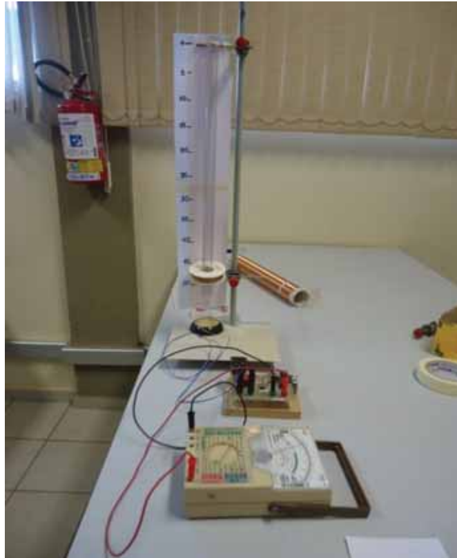
Figura 21 - Montagem experimental para a conversão de energia potencial gravitacional em energia elétrica.
