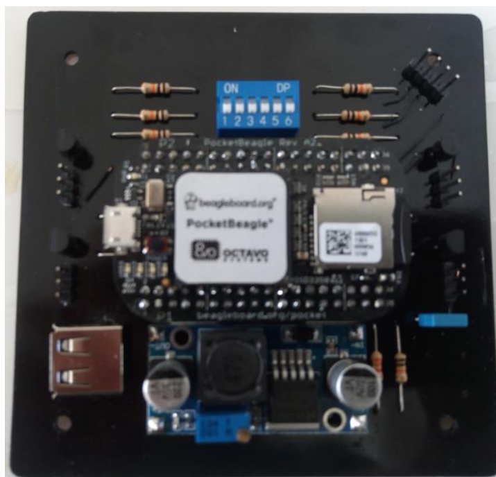
Figura 3.15 – PCI de Controle com a SBC.
