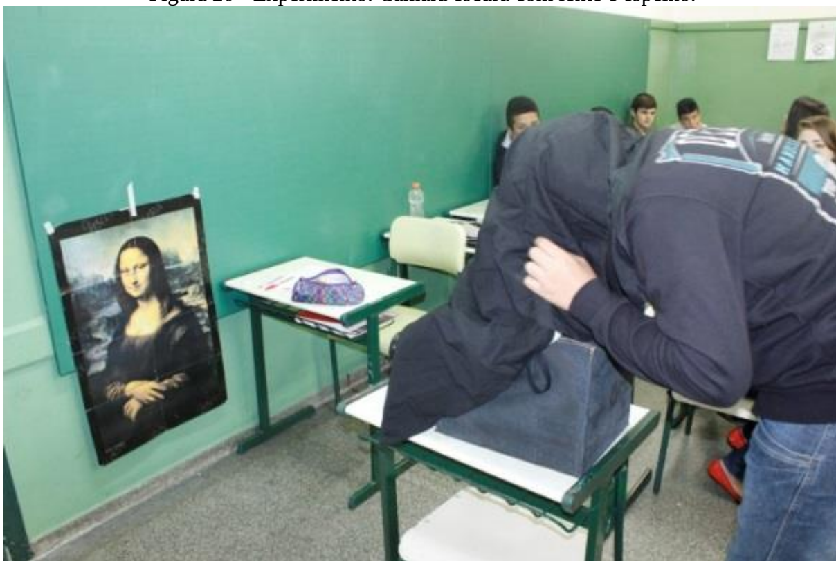
Figura 20 - Experimento. Câmara escura com lente e espelho.
