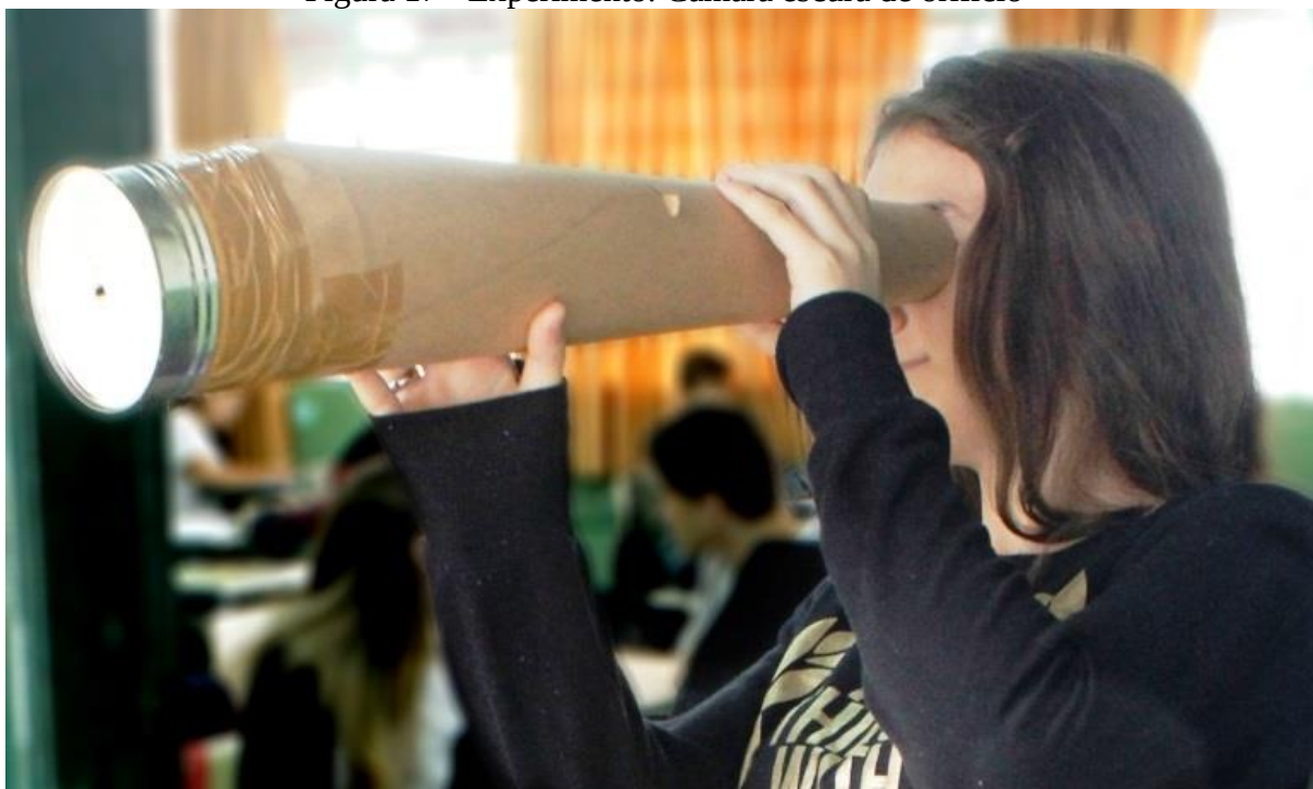
Figura 17 - Experimento. Câmara escura de orifício
