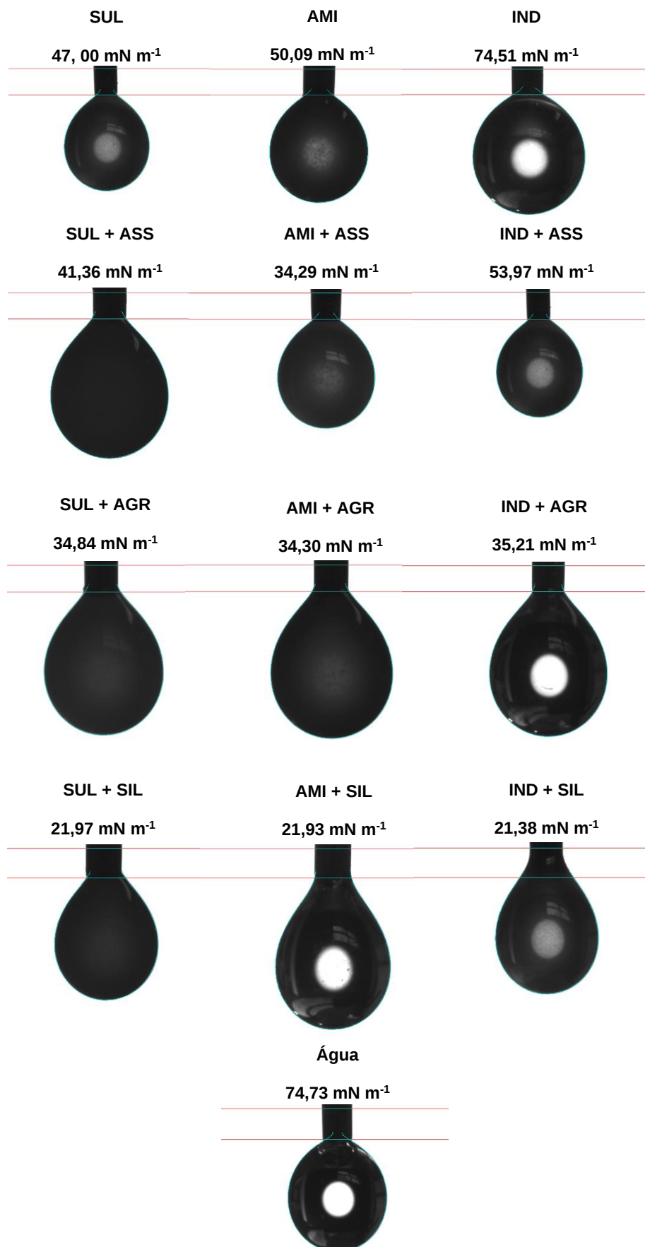
Figura 31 – Imagens capturadas pelo método de gota pendente da tensão superficial, analisadas pelo equipamento tensiômetro (Contact Angle System OCA 15-Plus (Dataphysics®), aos 10 segundos de leitura de formação da gota
