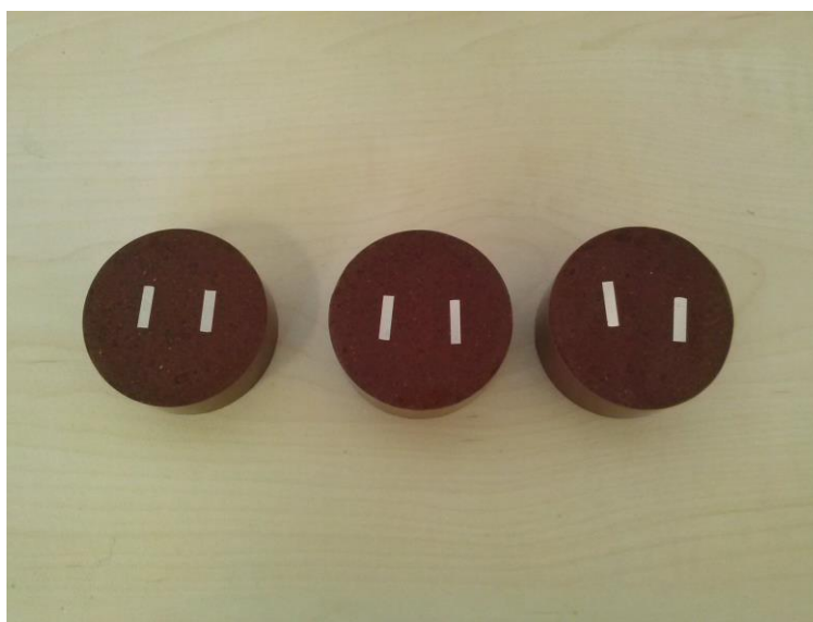
Figura 13 – Amostras embutidas em baquelite.
