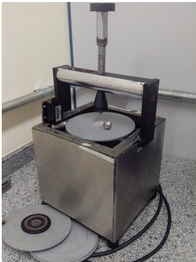
Figura 19 – Equipamento de ensaio Pino sobre disco do Laboratório de Materiais do IFSP - Itapetininga.
