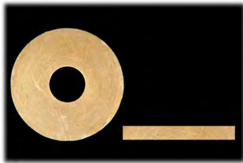
FIGURA 2 – Vista superior e lateral da matriz metálica com perfuração central de 9,0 mm x 3,0 mm.
