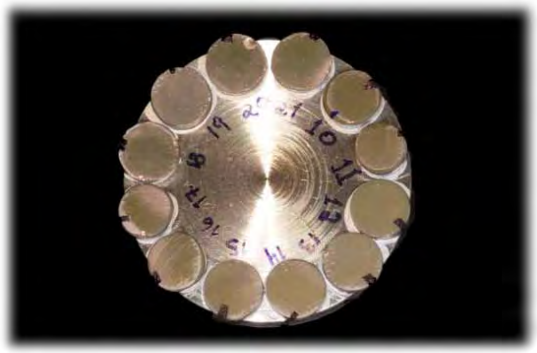
FIGURA 7 – Amostras cerâmicas posicionadas no stub e cobertas com ouro.
