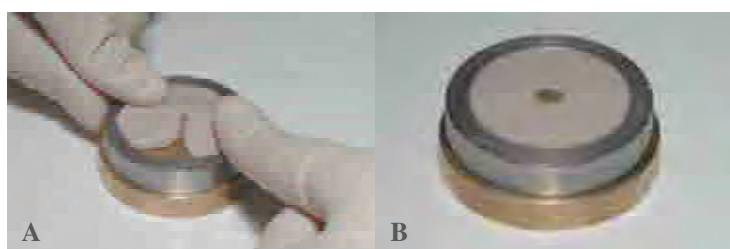
FIGURA 6 - Obtenção do molde de silicone: A) Condensação do silicone no interior da matriz metálica; e B) Silicone já condensado.
