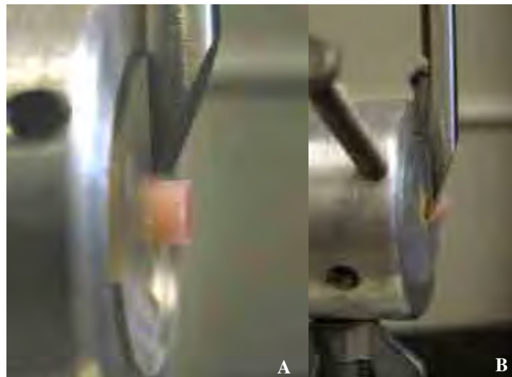
FIGURA 18 - A) Espécime fixo à matriz metálica e com o cinzel paralelo ao polímero de embutimento; e B) Fratura do espécime.
