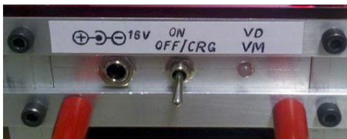
Figura 3.15 – Conector de Recarga, chave L/D e LED de sinalização na lateral do Kihon.
