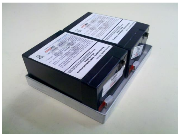
Figura 3.14 - Disposição das baterias empregadas.
