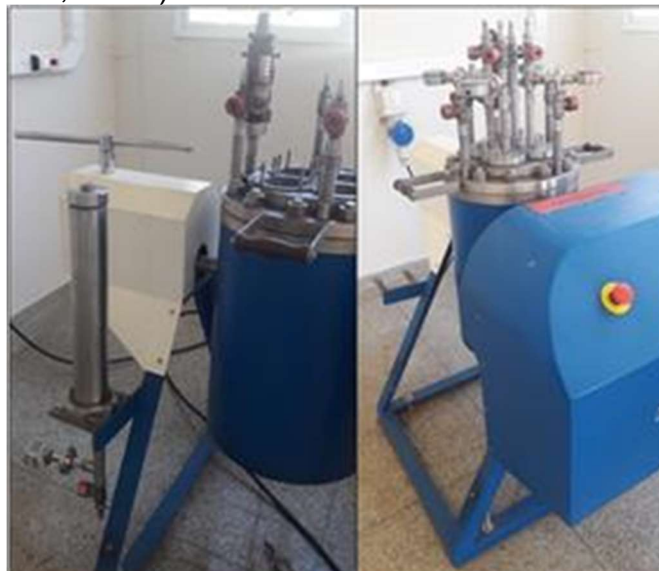
Figura 9. Equipamento composto de 4 reatores individuais de aço inoxidável (®Regmed, Osasco-SP, Brasil).
