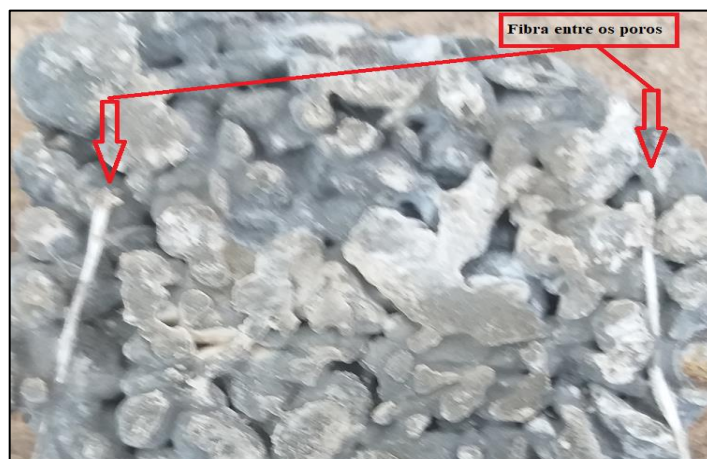
Figura 39 - Fibra de Vidro (AR) nos Poros do Concreto Permeável
