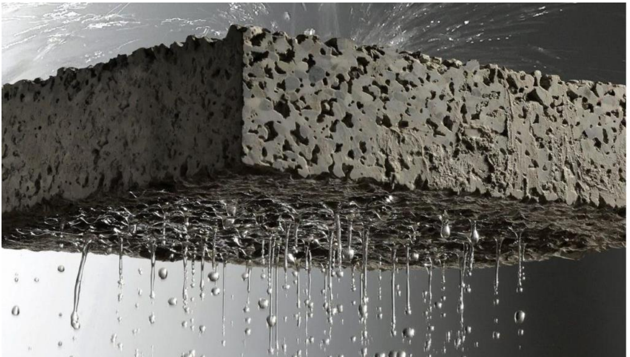
Figura 3 - Pavimento de Concreto Permeável
