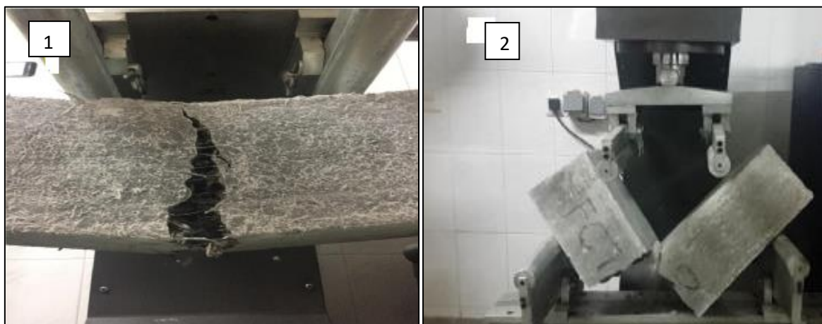
Figura 23 - Corpo de Prova de Concreto Convencional com Adição de Fibras Rompido (1), Corpo de Prova sem Adição de Fibras Rompido (2)
