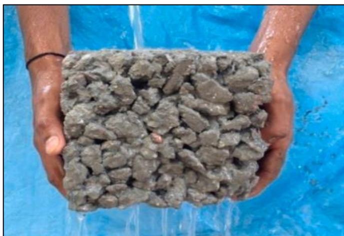
Figura 18 - Concreto Permeável em Funcionamento
