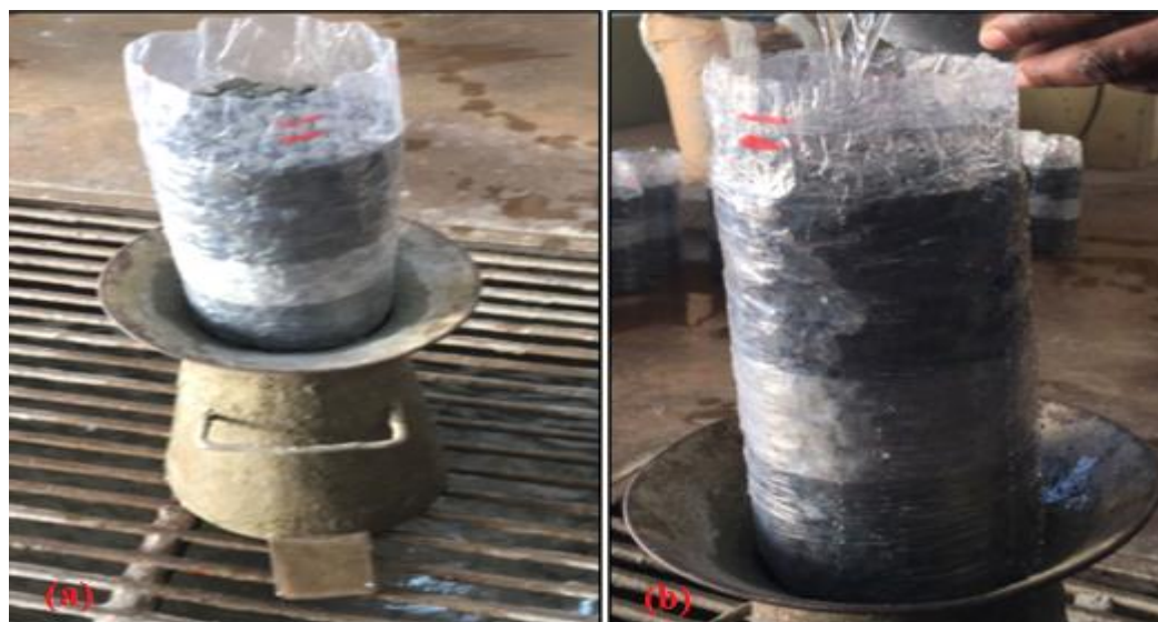
Figura 29 - Amostras Envoltas por Material Plástico Fino de Polímero
