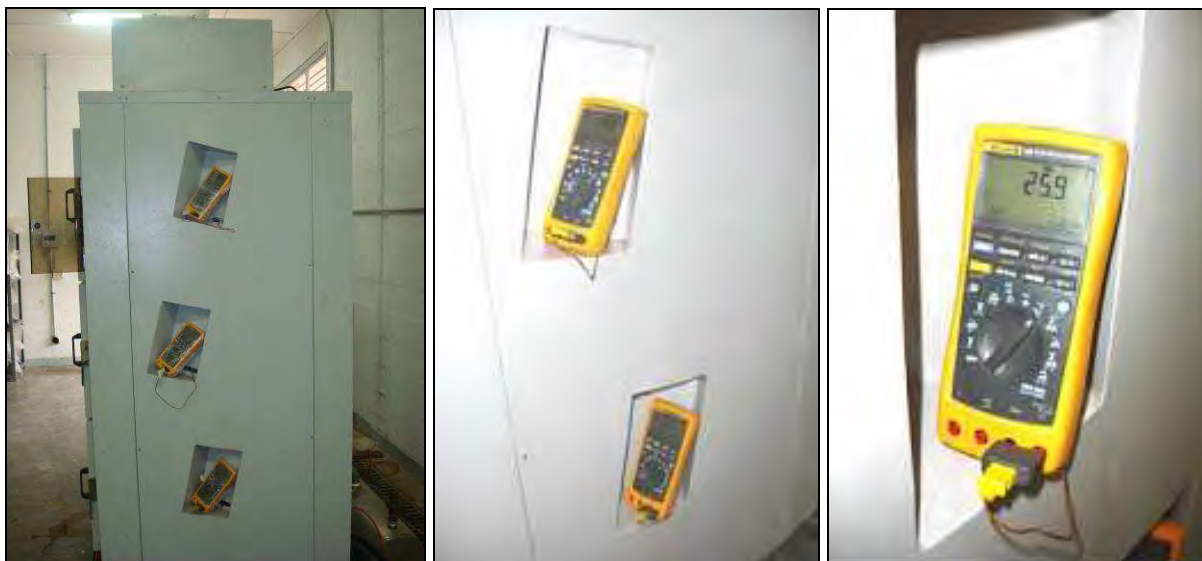
Figura 3.26: Multímetros conectados nos corpos-de-prova para monitoramento da temperatura.
