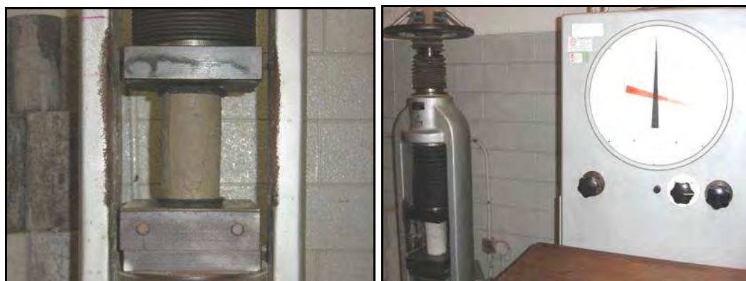
Figura 3.19: Ruptura dos corpos-de-prova.
