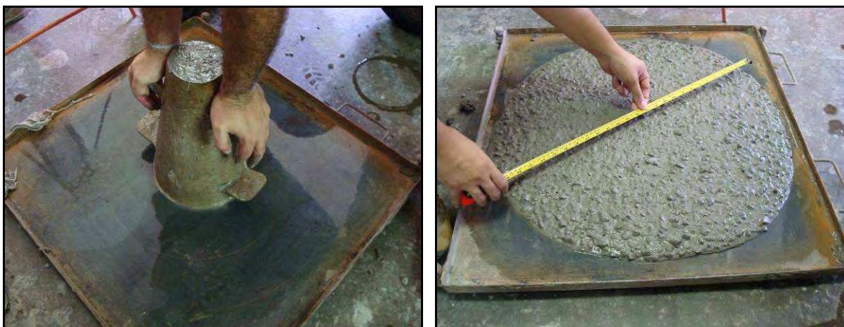
Figura 3.15: Ensaio de espalhamento com o CAA.
