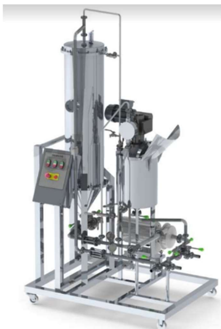
Figura 8 – Filtro tipo Vela de uma microcervejaria.
