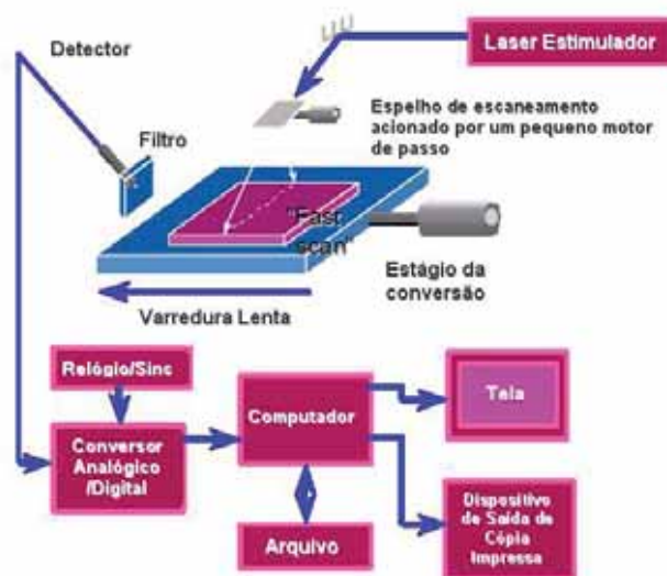
Figura 6: Leitura e apresentação da imagem na estação de aquisição. [D. oliveira & T. Lopes]
