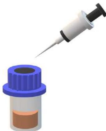
**Figura 33.** Esquema para introdução da seringa com  $\text{ZnCl}_2$  no reator.
