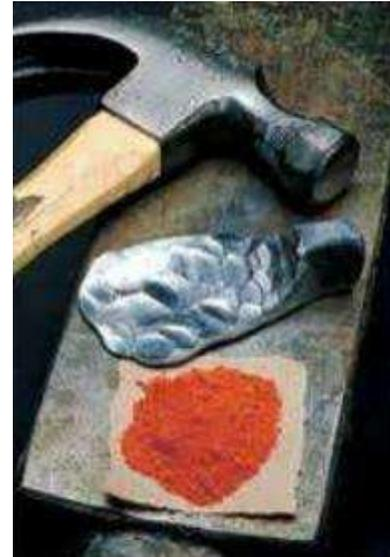
**Figura 13.** A peça de chumbo foi achatada por um martelo, porém os cristais cor de laranja do composto iônico óxido de chumbo(II) se quebraram.
