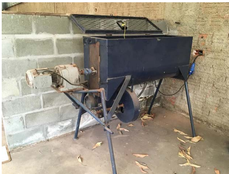
Figura 3. Equipamento com revolvimento mecânico.
