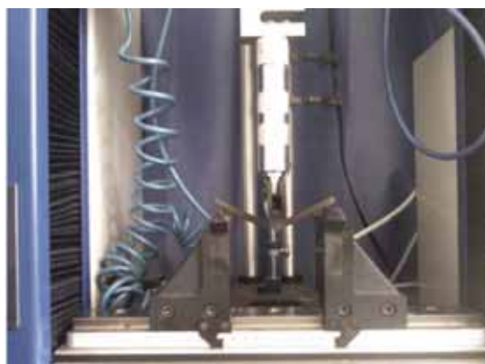
Figura 24 - Equipamento utilizado nos ensaios mecânicos de flexão.
