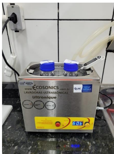
Figura 11 – Ultrassom utilizado para produção do biodiesel
