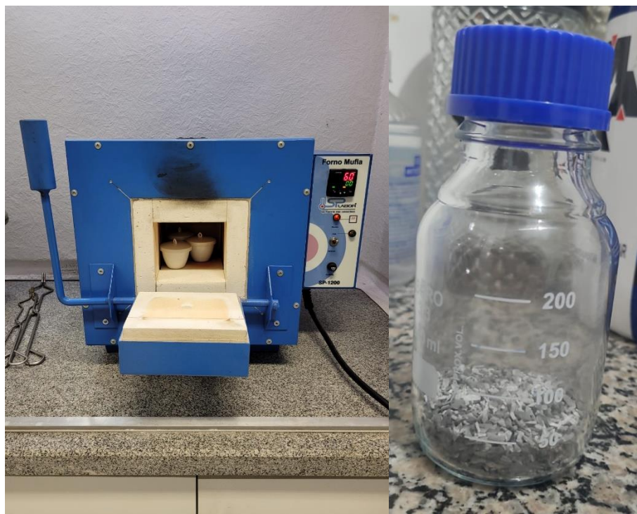
Figura 15 – Cadinhos com os ossos de galinha dentro da mufla e calcinação completa dos ossos
