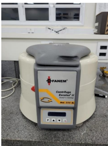
Figura 13 – Centrífuga para separação da glicerina com o biodiesel
