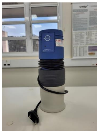
Figura 3 - Moinho analítico utilizado para triturar as sementes de abóbora
