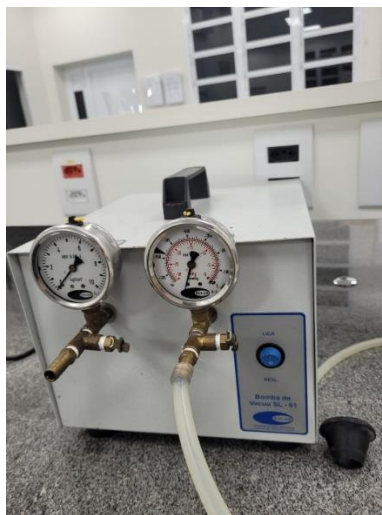
Figura 12 – Utilização de um filtro a vácuo para separação do catalisador
