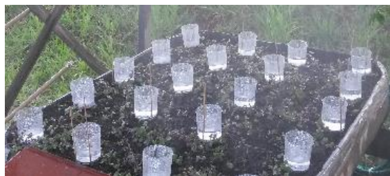
Figura 7. Exemplo de disposição de béqueres para realização do teste de CUC.
