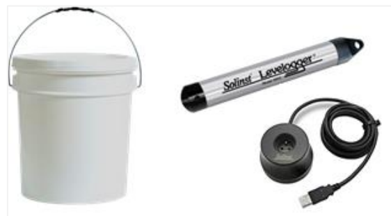
Figura 8. Recipiente industrial e levelogger para aquisição de dados de nível d'água.
