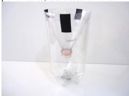
Figura 3: Recipiente coletor de água pluviométrica, feito artesanalmente
