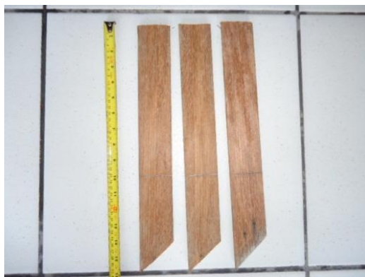
Figura 5: Estacas demarcadas, objeto metodológico para fixação e medição da erosão
