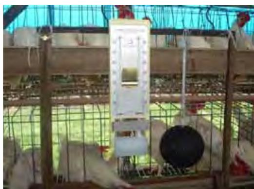
Figura 14– Termômetro de bulbo seco e bulbo úmido e termômetro de globo negro instalados no interior dos sistemas
